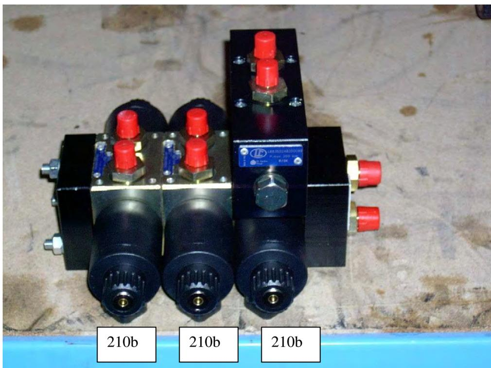
photo 14 – distributeur fonction panier « 3 tranches » / *Cage electro valve*
