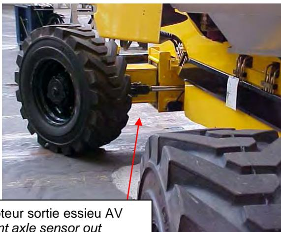
Capteur sortie essieu AV
