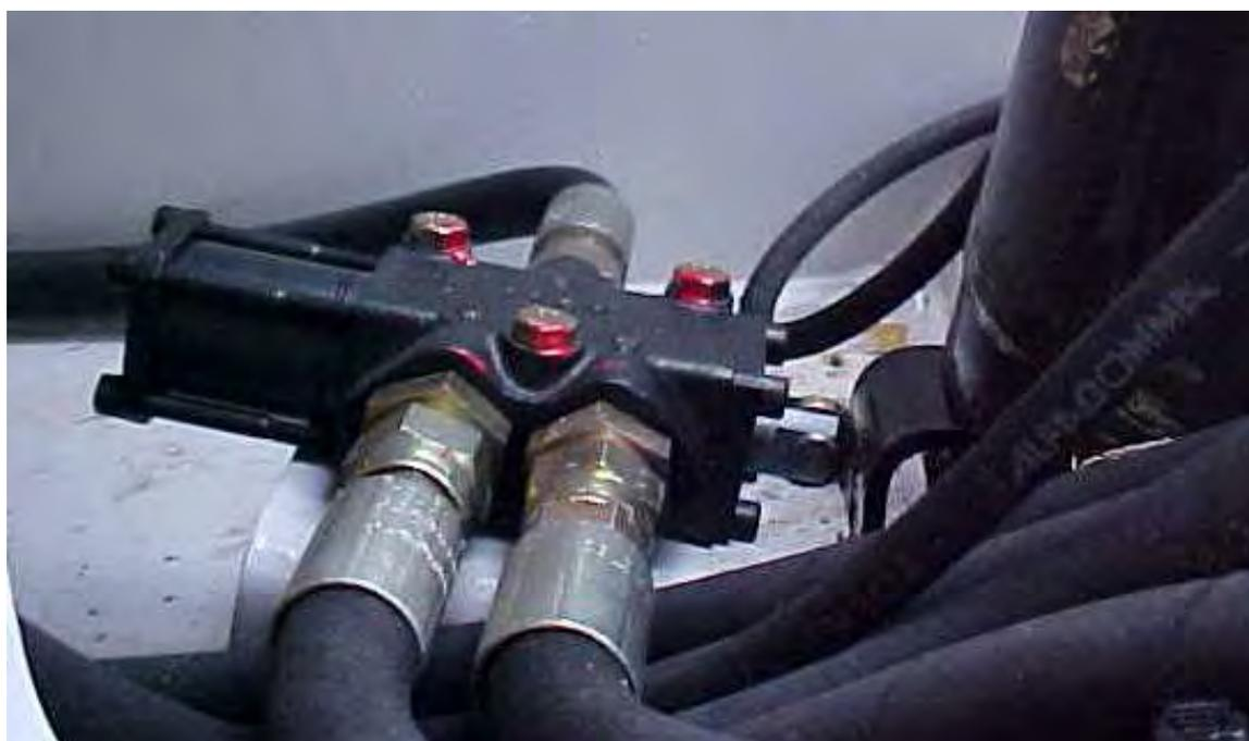
capteur hyd. derrière le vérin de relevage bras / *hyd. captor rear of arm raising cylinder*
